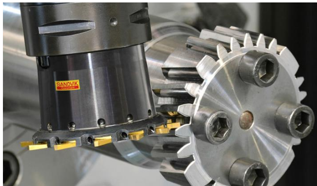
Рисунок 2 – Обробка дисковими фрезами серії CoroMill
